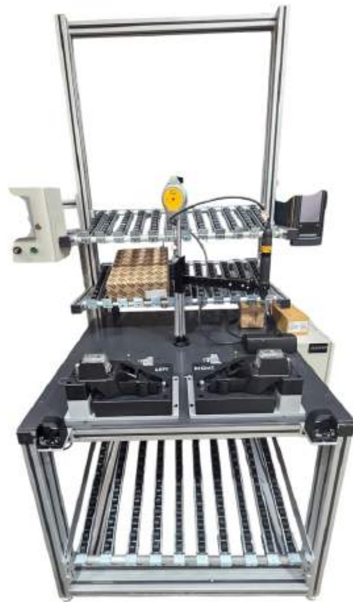
MESA DE ENSAMBLE Y TORQUE DE FOCOS CON POKAYOKE DE POSICIONAMIENTO
