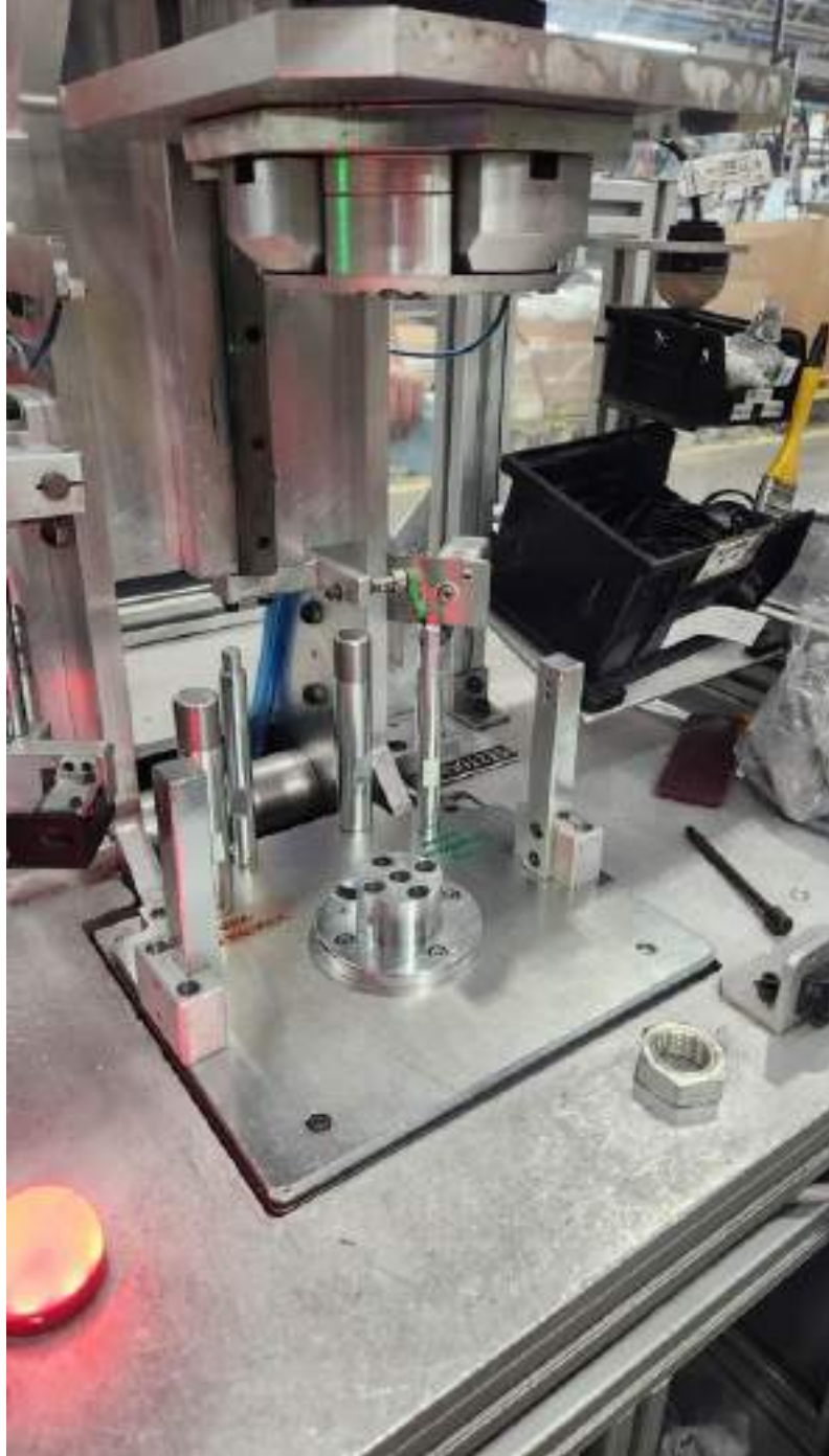
PRENSA DE INSERCIÓN DE WEAR RING
