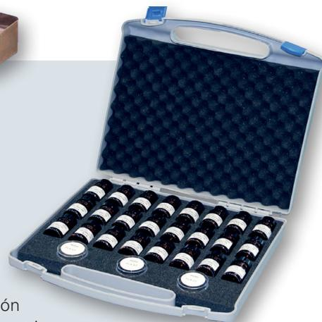
Soluciones específicas para la industria, aplicaciones basadas en el análisis mediante fluorescencia de Rayos X (XRF) para lograr un máximo rendimiento analítico en diferentes materiales. Estos paquetes incluyen no sólo las normas certificadas internacionales, sino también muestras de referencia, muestras de corrección del drift y el CD de instalación. Es una solución completa con curvas de calibración desarrolladas en fábrica.
