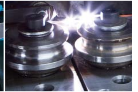
Soldadura con wolframio y gas inerte (WIG)
