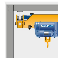
Versión sobre tacos, variante 2 (máxima altura de gancho sin voladizo de viga)
