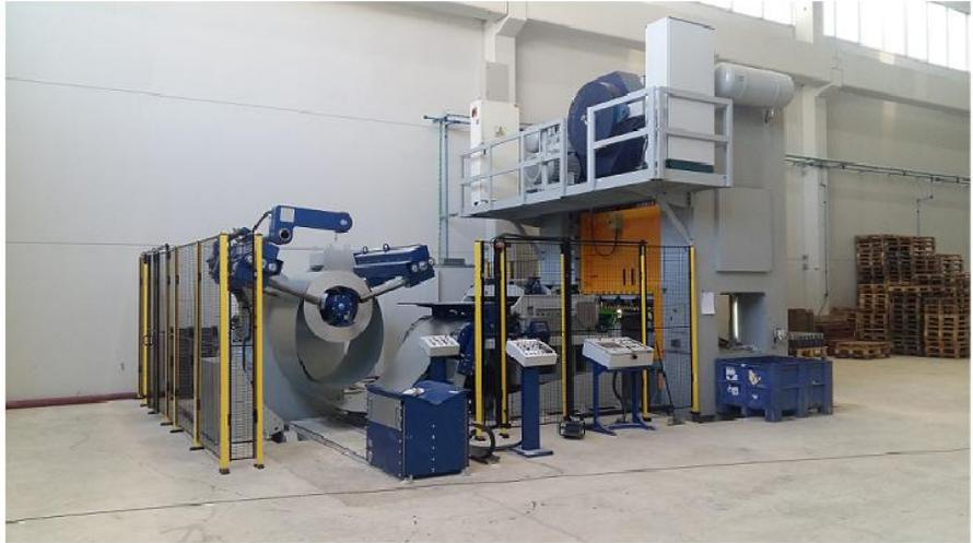
*Línea de enderezado y corte longitudinal y transversal partiendo de lámina en rollo.*
