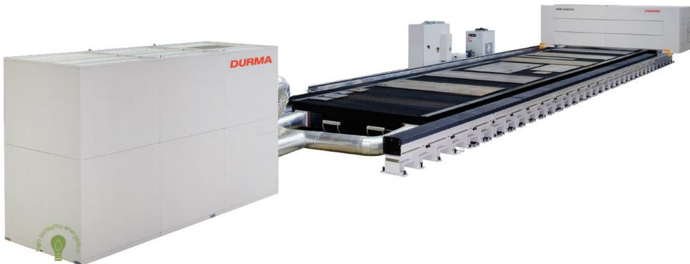
Láser de Fibra diseñado exclusivamente para procesar tubos y perfiles, la serie HD-TC cuenta con un cargador automático de hasta 3 toneladas, reconocimiento y dimensionado automático del tubo o perfil, fuentes IPG con potencia disponible desde 1 hasta 4 KW, descarga automática del tubo de 3 o 6 metros de longitud y mediante banda para piezas de menor dimensión.
