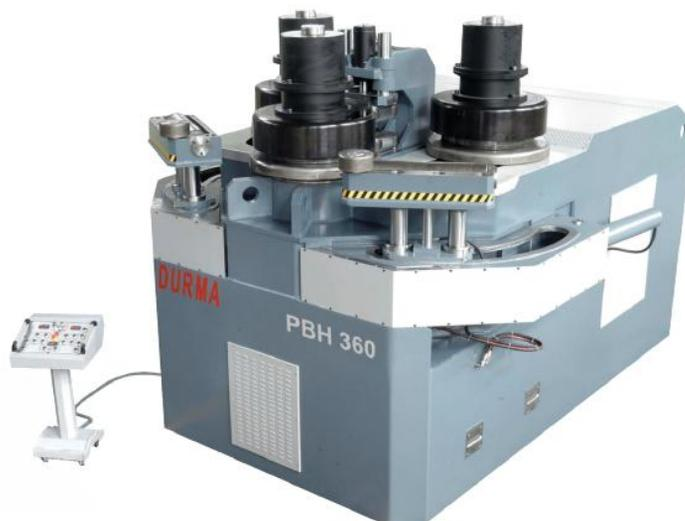
*Curvadoras de perfiles para radios fijos amplios, con 3 rodillos motrices y rodillos de acompañamiento y correctores laterales para conseguir curvas perfectas en diversos tipos de perfiles como la solera, PTR, canal, viga, tubo, etc. Maquinas de accionamiento hidráulico y posibilidad de tener controles numéricos o CNC*
