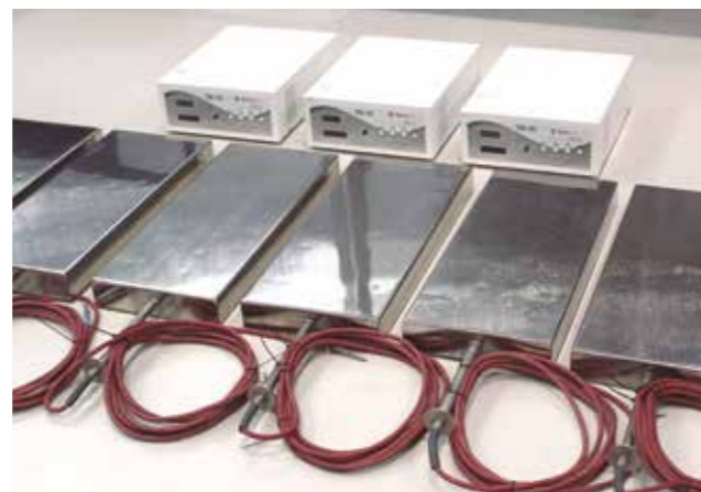
Emisores recubierto en capa de cromoduro de 30 micras.
