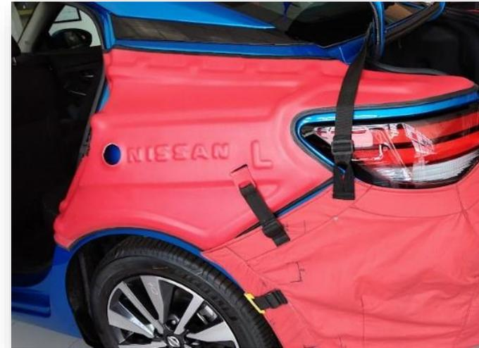
**Protecciones para Cuartos con sistemas de Auxiliares para Protecciones complementarias.**
