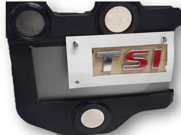
**Plantillas para colocación de emblema, maquinado y Vaciado**
