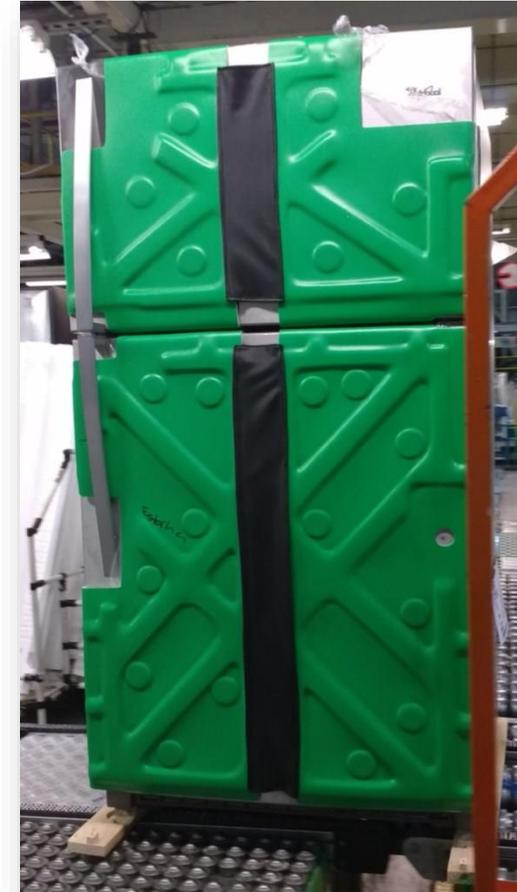
**Protecciones Rígidas para Refrigeradores.**
