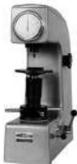
MEDIDOR DE DUREZA
