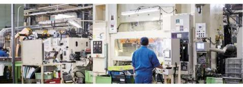
ファインブレスとは、当社が独自開発した精密打ち抜き加工技術で、汎用のプレス機を使用して100%せん断加工を行います。ファインブランキングとは 異なり、金型にクサビを用いないため、板材以外の切り離された素形材からの100%せん断加工も可能です。高い精度、面組さが得られる事から、打ち抜き 面に機能を求められる製品に対し、有利な加工技術です。
