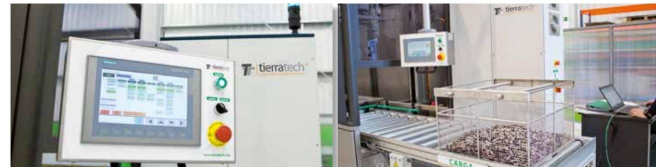
Pantalla SIEMENS mod. KTP900 TFT panorámica de 9". Retroiluminada de 800 x 480px. Todos los equipos automáticos tienen instalada esta pantalla de serie.
