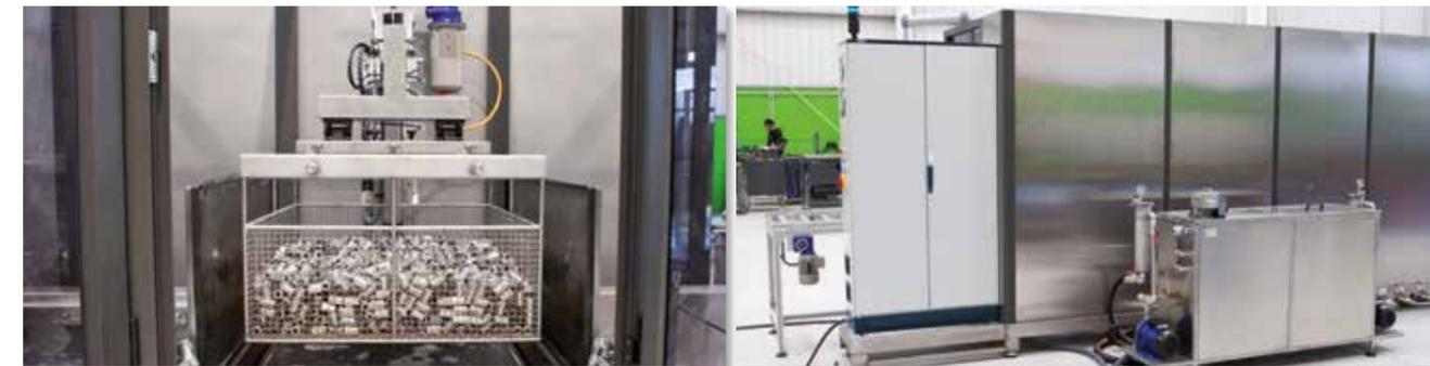
Detalle de cesta saliendo de cuba de aclarado en caliente. Los equipos multietapa pueden tener varios tipos de secado y pasivado de piezas.
