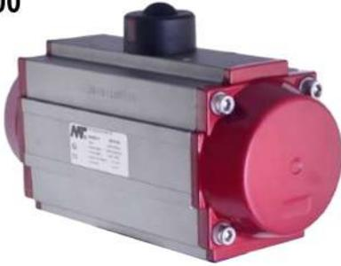
Actuadores neumaticos piñon - cremallera 1/4 de vuelta (90°) simple efecto (5100) y doble efecto (5200), doble taladro inferior para anclaje a válvula según norma: ISO 5211 / DIN 3337 para montaje a 45° o 90°.
