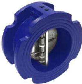
Válvula de retencion doble disco de acero inoxidable 316 (DUOCHECK) cuerpo de fundicion nodular, bridas EN-1092-2 PN-10/PN-16, ANSI B16.5.
