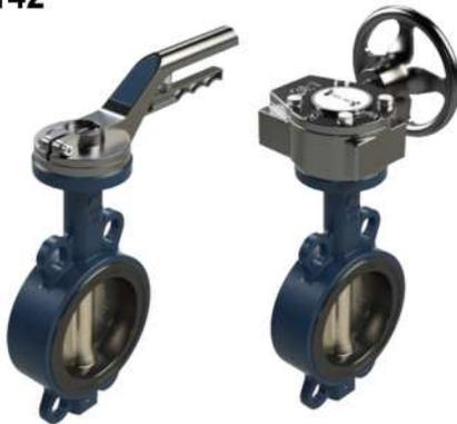
Válvula de mariposa WAFER, disco de acero inoxidable 316, cuerpo de fundicion nodular asiento refaccionable EPDM y NBR, bridas EN-1092-2 PN-10/PN-16, ANSI B16.5.
