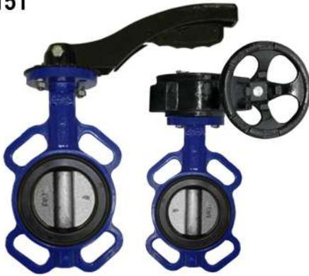
Válvula de mariposa WAFER, disco de acero inoxidable 316 (51151) y fundición dúctil (5115) cuerpo de fundición gris (2" - 6") y de fundición dúctil (8" - 24"), asiento rígido, bridas EN-1092-2 PN-10/PN-16, ANSI B16.5.
