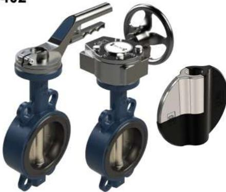
Válvula de mariposa WAFER, disco de fundición nodular recubierto en poliamida 11 (RILSAN) cuerpo de fundición nodular, asiento refaccionable EPDM y NBR, bridas EN-1092-2 PN-10/PN-16 ANSI B16.5.
