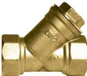
Filtro "Y" con cuerpo de latón y tamiz en acero inoxidable, roscas NPT según ANSI-ASME B.1.20.1
