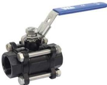
Válvula de esfera de tres piezas de acero al carbon y esfera de acero inoxidable 304, paso completo sistema de bloqueo de palanca.
