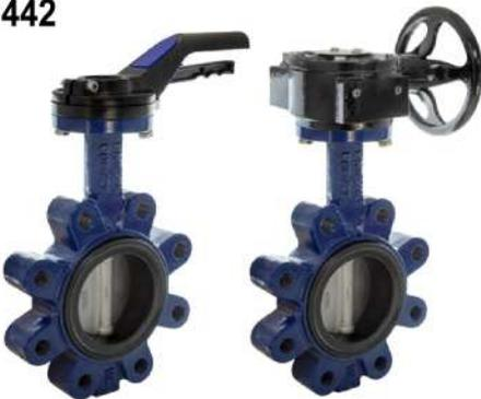
Válvula de mariposa LUG, disco de acero inoxidable 316, cuerpo de fundición nodular, asiento rígido EPDM (51442) y NBR (5144) bridas preparadas según norma ANSI 150
